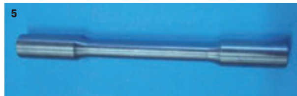
5. Provino, sagomato da sottoporre direttamente a prova dopo la verifica delle tolleranze
